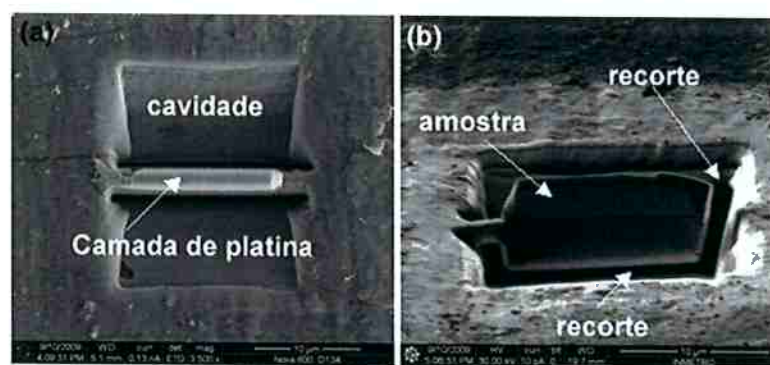
Figura 21. – Exemplo de FIB: (a) microusinagem (cavidades) e deposição de camada de platina; (b) detalhe a amostra de 12 \mu\text{m} a ser retirada para análise (10).
