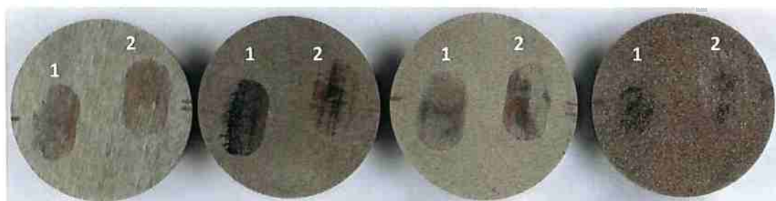
Figura 29. – Discos de ferro fundido cinzento. Da esquerda para direita: disco lixado (GGg), eletroerodido-1 (GGe1), eletroerodido-2 (GGe2) e eletroerodido-3 (GGe3). Material particulado: 1: \text{Fe}_3\text{O}_4 + 30% grafita / 2: \text{Fe}_3\text{O}_4 .
