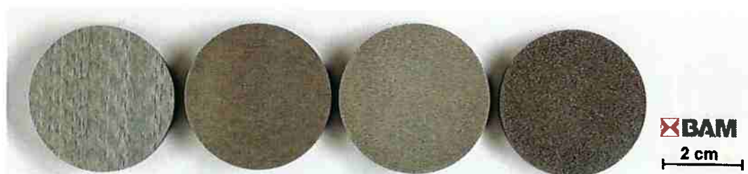
Figura 17. – Discos de ferro fundido após eletroerosão. Da esquerda para direita: disco lixado (GGg), eletroerodido-1 (GGe1), eletroerodido-2 (GGe2) e eletroerodido-3 (GGe3).
