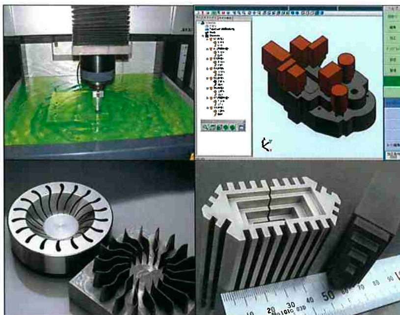
Figura 11. – Flúido dielétrico durante processo de eletroerosão. Integração do CNC com software de CAD. Exemplos peças usinadas por eletroerosão (13).
