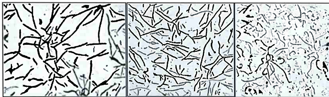
Figura 7. – Microscopia óptica: ferro fundido cinzento sem ataque (105x, 100x; 100x), com veios de grafita (escura) (9).
